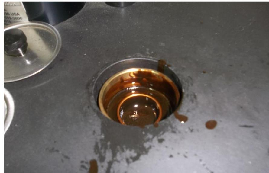
Llenamos el orificio mas arriba del anillo de confinamiento, manteniendo la temperatura en 104 °F
