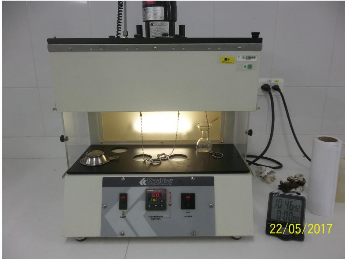
En este proceso por medio del laboratorio Y el viscosímetro hayamos la viscosidad Cinematica, que se haya contabilizando el tiempo de flujo para el paso de 60 ml de muestra de crudo fluyendo a través de un cilindro con un orificio calibrado.
