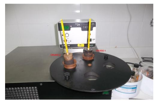
Sometemos las muestras a un enfriamiento con su respectiva medición de temperatura con un termómetro, partimos de 20 °C.
